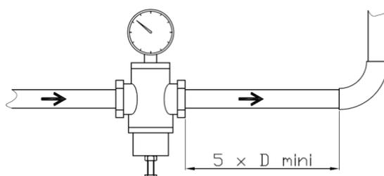
**Sectionnement amont :** prévoir un robinet d'arrêt en amont du réducteur PRV. Celui-ci n'est pas forcément étanche à débit nul et ne constitue pas un organe de sectionnement.
